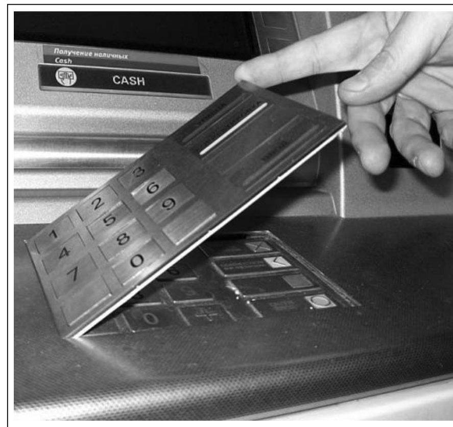
Накладка на клавиатуру банкомата, снимающая вводимый пин-код [97]
