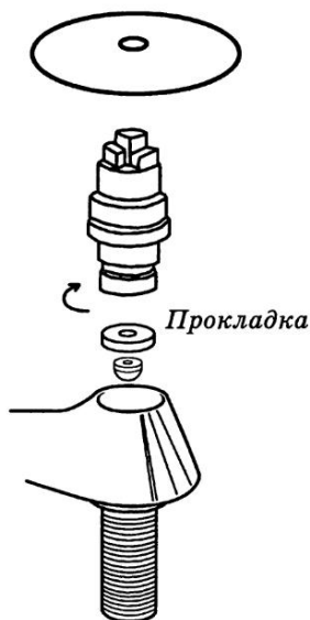
Рис. 95. Замена прокладки в кране
