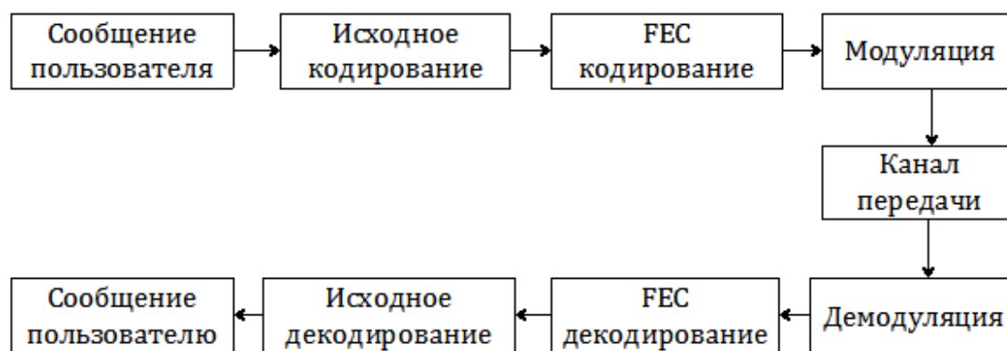
Рис.9.4. Блок-схема информационных потоков в системе цифровой связи
