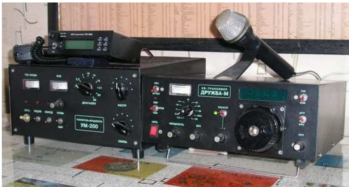
Рис.2.6. Трансивер «Дружба-М» и усилитель мощности «УМ-200»
