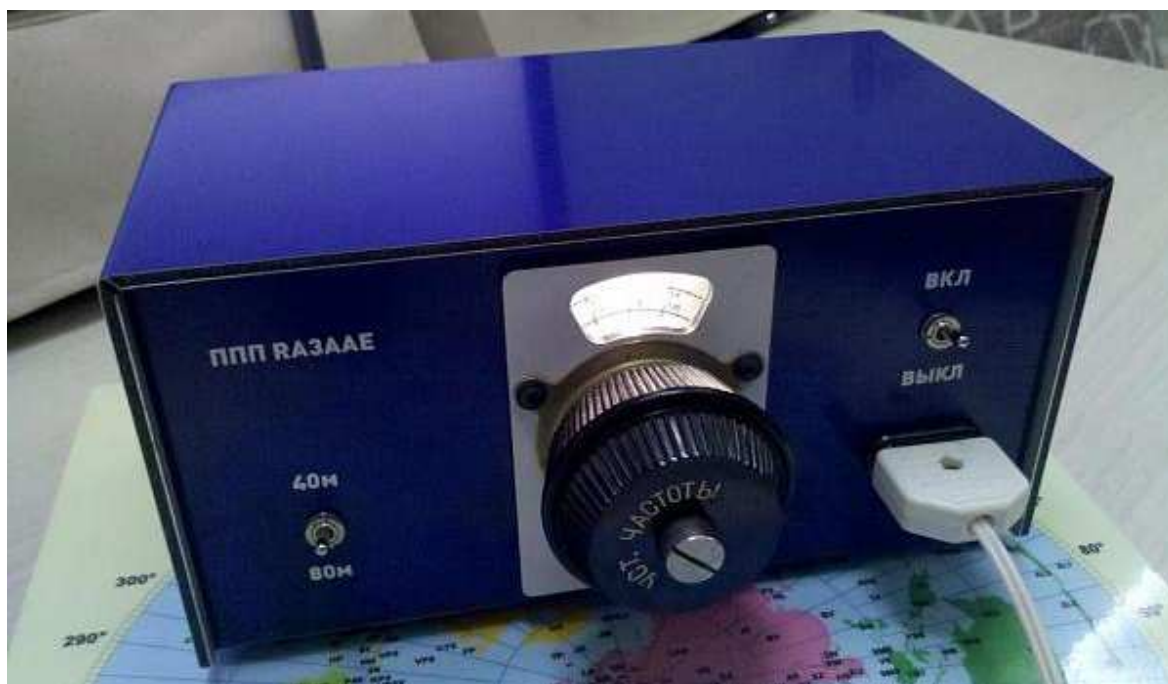
Рис.2.7. Приемник прямого преобразования В.Т. Полякова (РА3ААЕ) на 40 и 80 м.
