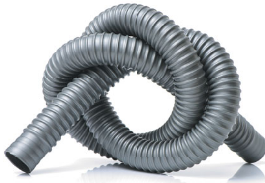
Гибкая пластиковая канализационная подводка для соединения сантехнических приборов с трубами. Ее устанавливают так, чтобы изгибы создали сифон, препятствующий прорыву газов из системы канализации
