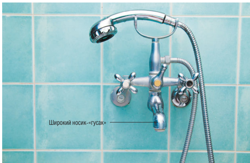
Смесители для ванны с душем чаще делают неповоротными, с широким носиком-«гусаком», поскольку их основная задача — побыстрее наполнить ванну
