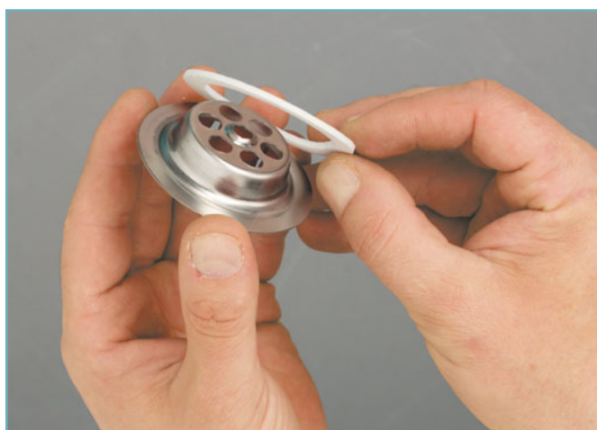
8 Надеваем уплотнительное кольцо на решетку мойки.
