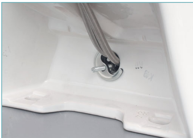
8 Устанавливаем С-образную пластину.
