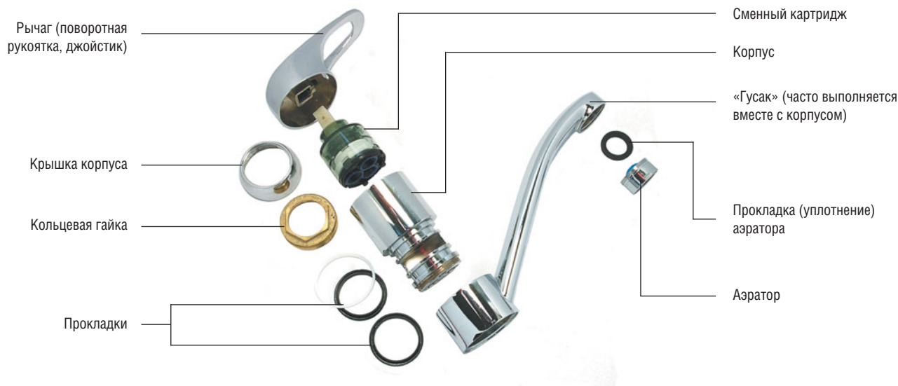
Строение однорычажного смесителя
