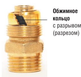
Компрессионный фитинг без накидной гайки (наворачивается на верхнюю резьбу)
