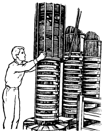
Рис. 75. Насадка обмотки трансформатора мощностью 6300 кВ·А
