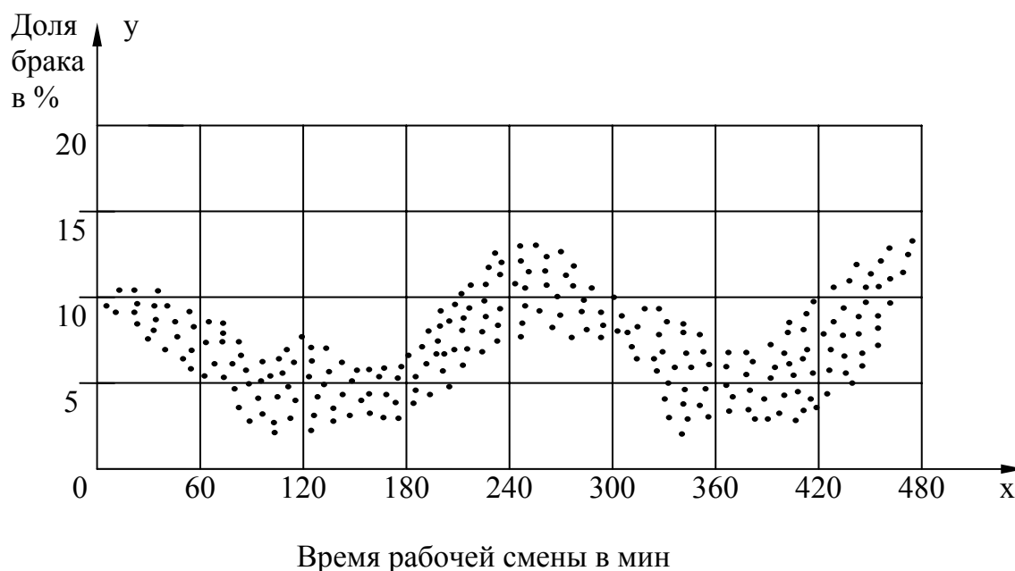
Рис. 48. Диаграмма рассеивания доли бракованных изделий в зависимости от времени их изготовления
