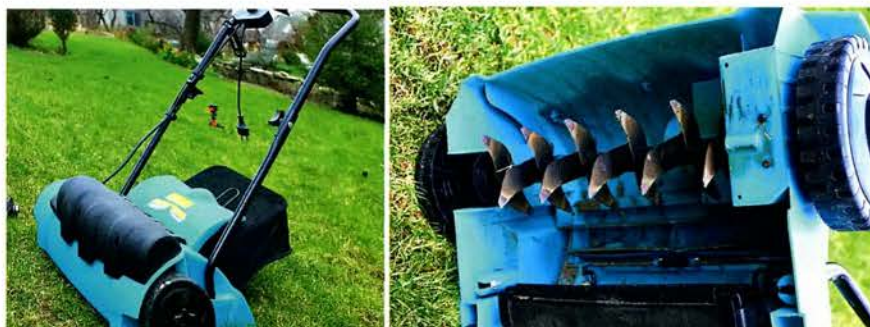
Скарификатор — тот же аэратор, только он не протыкает, а надрезает почву для обогащения её кислородом. Чаще используется для газонов. На небольших, в 6–8 соток участках модели с электроприводом более чем уместны.
