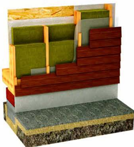
Стены каркасных домов утепляют матами из базальтовой ваты и зашивают снаружи плитами ОСП, после чего следуют слой фасадного утеплителя, гидроизоляционный слой и фасадный материал.
