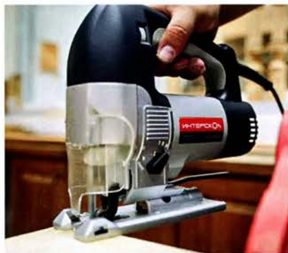
Лобзик с литой опорной платформой (подшовой). Перед пилкой установлен прозрачный защитный экран. «Интерскол» МП100/7003.
