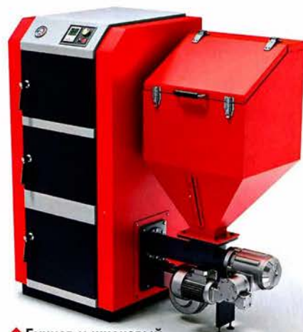
↑ Бункер и шнековый механизм с электромотором. В нижней части расположен механизм системы очистки горелки от золы.
