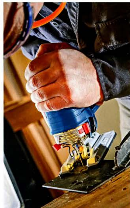
Способ распила металлической пластины предусматривает фиксацию заготовки струбциной на куске фанеры или доске. Для работ по металлу применяются специальные лобзиковые пилки. Bosch GST160CE.
