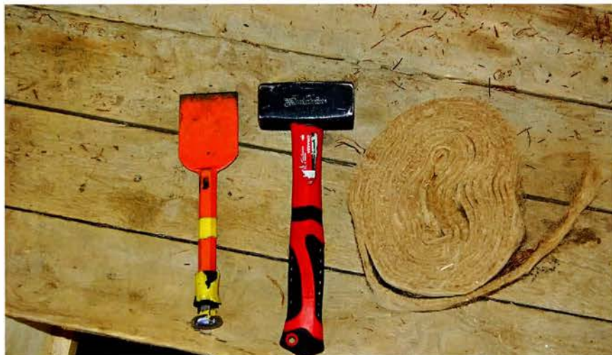
Инструменты для конопаточных работ.
