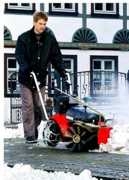
«Старшие» модели подметальщиков могут быть дополнительно оборудованы по сезону скребком-отвалом для снега или даже колёсными цепями, чтобы не буксовать на скользком покрытии. Tielburger TK 58.
