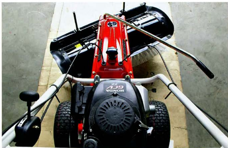
Вид глазами оператора подметальной машины. С помощью длинной ручки на переднем плане изменяют угол поворота щётки. Слева виден рычаг выбора скорости движения подметальщика.
