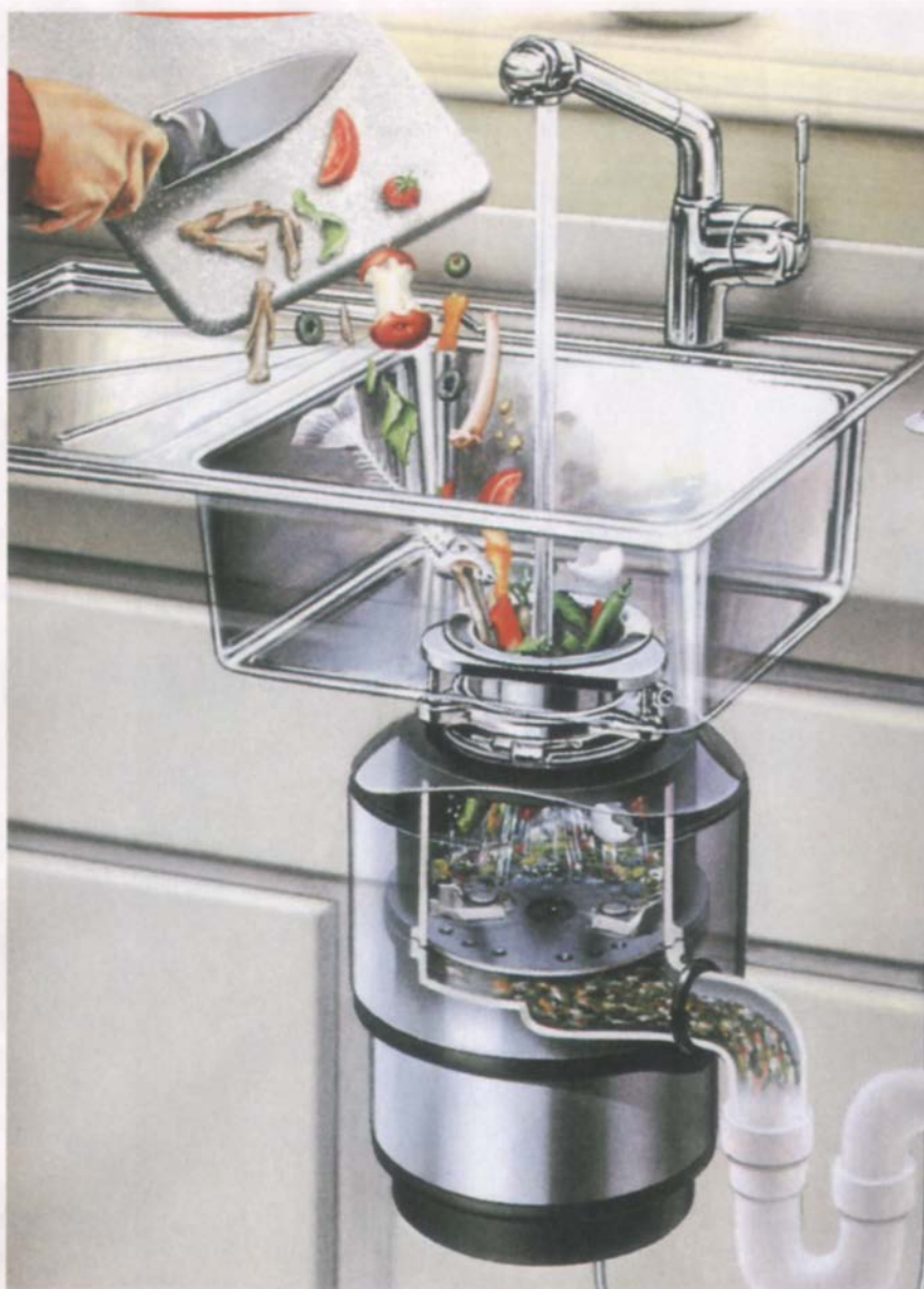
↑ Рис. 1. Схема работы измельчителя пищевых отходов.
