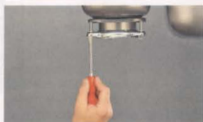
Установка горловины диспозера на мойку.
