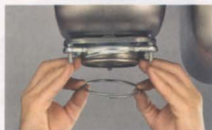
Подсоединение патрубка к диспозеру.
