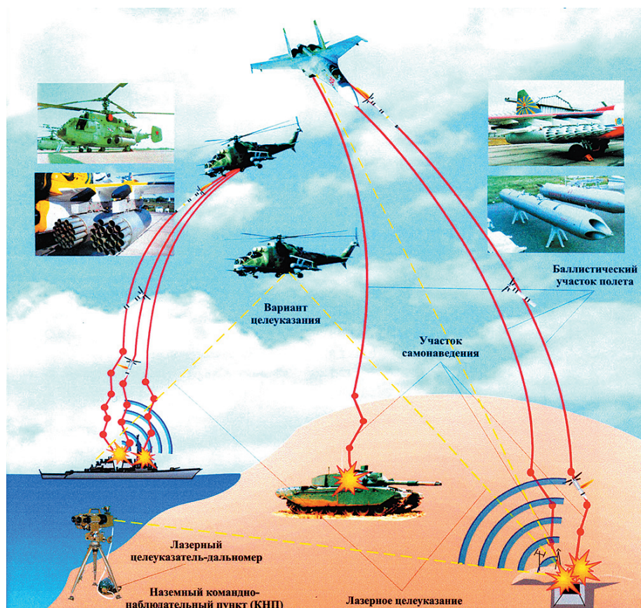
Варианты применения модернизированных авиационных ракет С-5Кор, С-8Кор, С-13Кор
