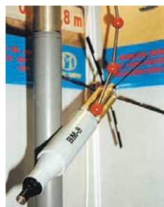
Макет самонаводящегося модуля БМ-8 с импульсными двигателями коррекции для модернизированной авиационной ракеты С-8Кор разработки ЗАО НТК «Аметех». МАКС-99
