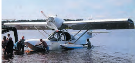
Гидросамолёт Л-471 с поплавком от Ан-2
