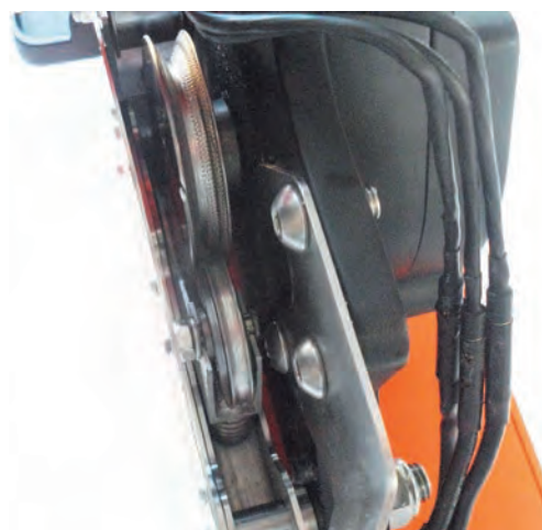
Для сцепления ручей приводного ролика выполнен с насечкой
