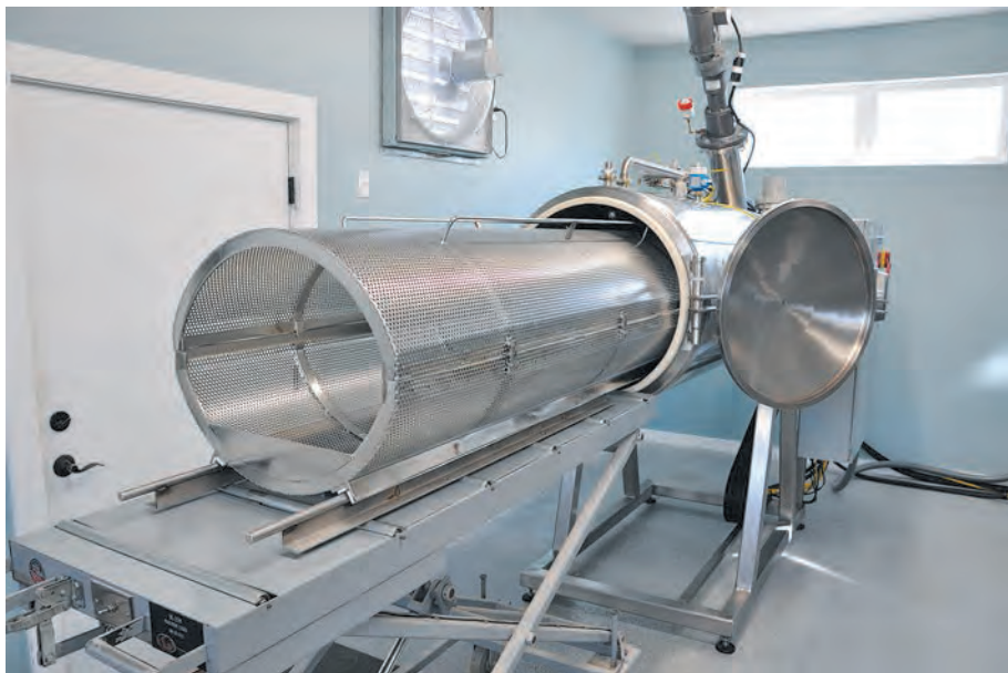
Камера для ресомации — щелочного гидролиза останков
