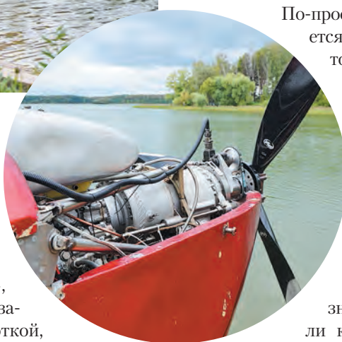
Это и есть турбостартер ГТДЗ-117 для запуска мощных двигателей, превращённый в турбовинтовой движитель для лёгкого самолёта
