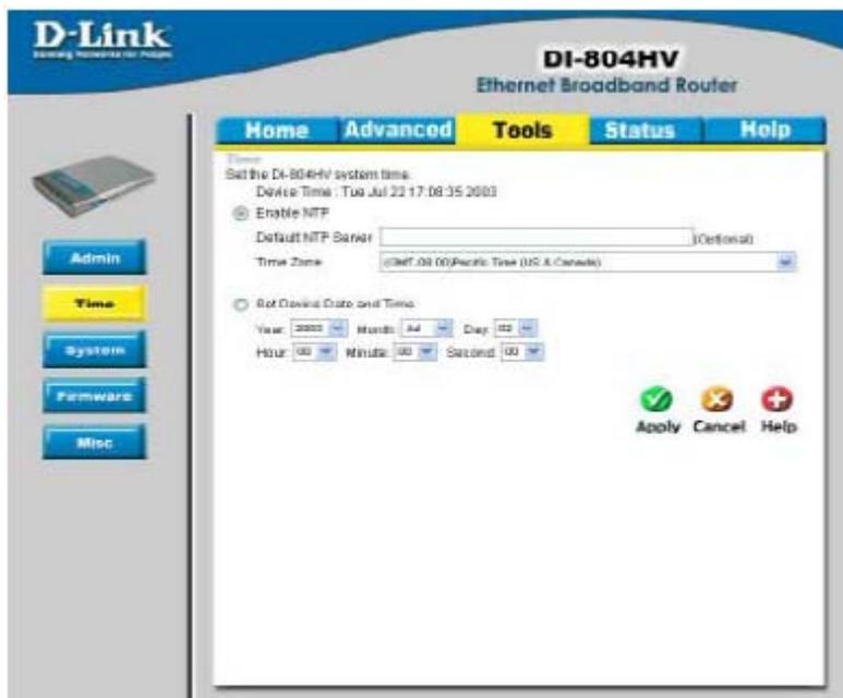
Установите системное время, введя его вручную или используя протокол NTP (Network Time Protocol, Протокол сетевого времени). Протокол NTP – это стандартный протокол Интернет, используемый для синхронизации времени DI-804HV.
