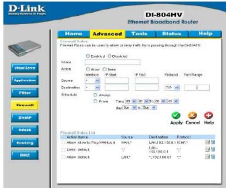
**Правила межсетевого экрана (Firewall Rules)** – это особая функция, используемая для запрещения или разрешения трафика, проходящего через DI-804HV. Она работает подобно IP-фильтрам с некоторыми дополнительными настройками. Межсетевой экран позволяет установить более детализированные правила доступа на DI-804HV.
