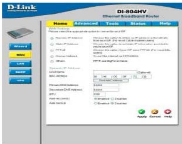
Большинство пользователей подключения через кабельный модем должны выбрать эту опцию для получения IP-адреса автоматически от ISP.
