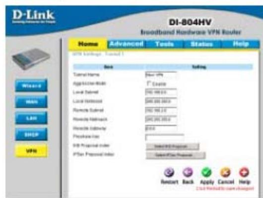
**Шаг 6** В поле Remote Gateway введите IP-адрес интерфейса WAN удаленного маршрутизатора DI-804HV, а в поле Preshared Key введите ключ, который должен совпадать с ключом Preshared Key, указанным на удаленном DI-804HV.
