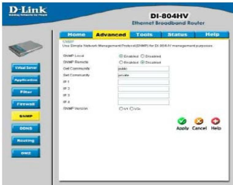
SNMP (Simple Network Management Protocol, Простой протокол сетевого управления) – это широко используемый протокол сетевого мониторинга и управления. Он может предоставлять администратору сети информацию о работе каждого сетевого устройства. SNMP может быть использован для мониторинга трафика и сбора статистических данных о работе DI-804HV. DI-804HV поддерживает SNMP v1 и v2c
