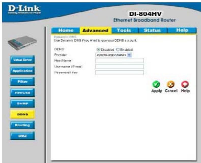
DDNS (Dynamic Domain Name System, Система динамических доменных имен) поддерживает связь динамического IP-адреса (например, IP-адреса, назначенного сервером DHCP) с доменным именем. Пользователи, имеющие учетную запись Dynamic DNS, могут использовать эту функцию на DI-804HV.
