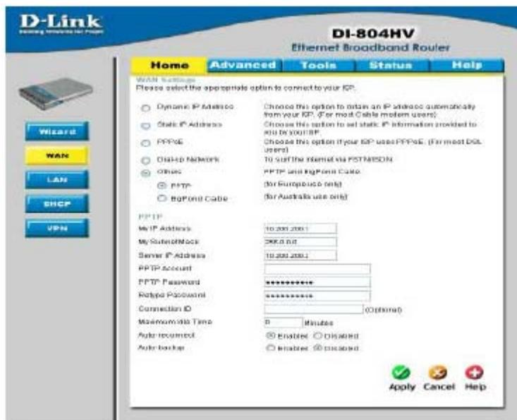
Протокол туннелирования точка-точка PPTP (Point-to-Point Tunneling Protocol) используется для подключения WAN в Европе.
