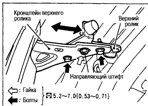
Регулировка верхнего ролика
