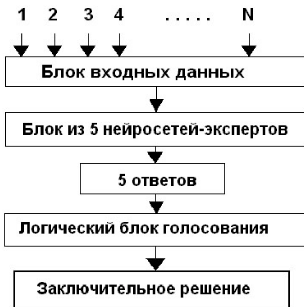
Рисунок 2.6. Схема движения информации для экспертной системы с 5 нейросетями-экспертами, решающими одну и ту же задачу и логическим блоком, осуществляющим голосование для выдачи заключительного решения
